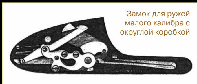
Замок льежского типа для штуцеров – «горизон- талок»
