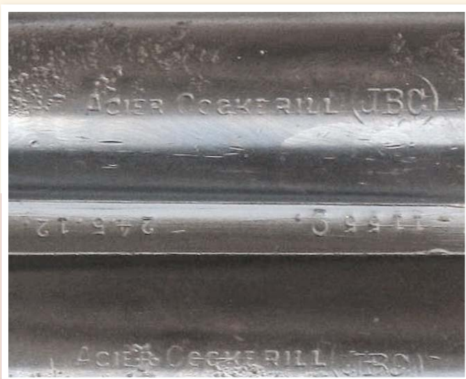
Илл. 7. Маркировка ствольного материала выполнялась на трубках под цевьём
