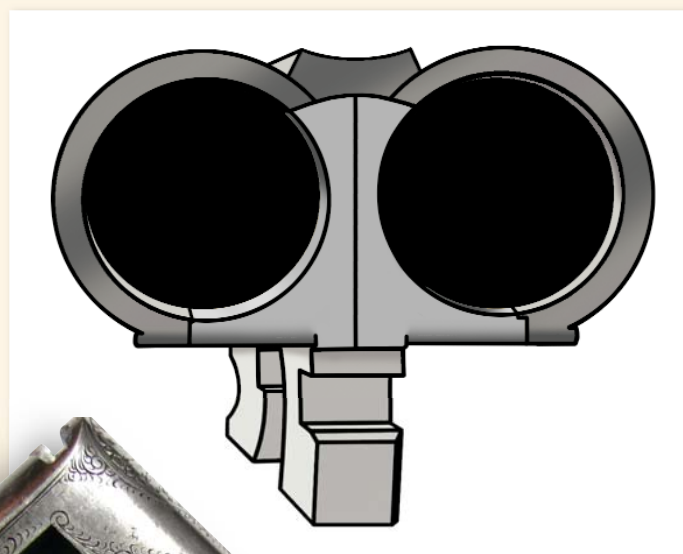
Илл. 2. При максимально разнесённых крюках увеличивается длина подушек коробки – ружьё выглядит солидно и изящно
